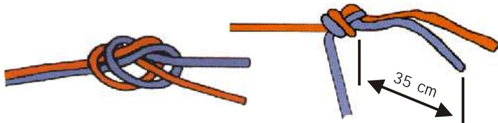
Nodo di giunzione tra due corde anche di diametro diverso per calata in corda doppia. Si prendono i capi delle corde da unire e si forma un nodo semplice, lasciando che i capi liberi siano come minimo lunghi 35 cm.
