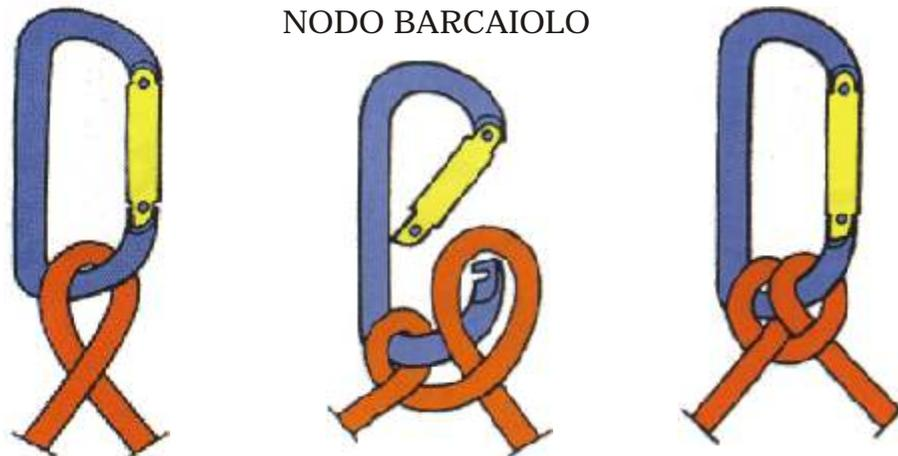
Serve per assicurare nelle soste e per il bloccaggio della corda - 1) NEL MOSCHETTONE: si passa il capo di sinistra dietro quello di destra costruendo un'asola e la si infila nel moschettone
